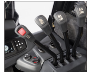
Palancas de control manual
