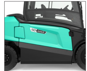
Puerta lateral del compartimento de la batería
